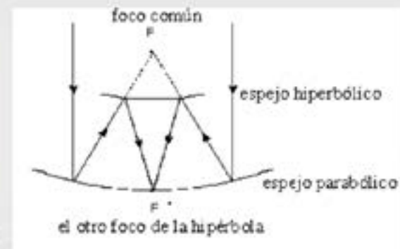
Funcionamiento conceptual del telescopio Cassegrain
